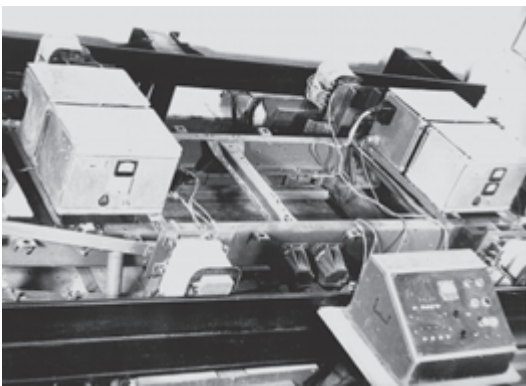
Фото 4. Макет транспортного екіпажу з 4-точковими системами електромагнітного підвісу та горизонтальної стабілізації масою 2500 кг (корпус №20 КПІ, 1981 р.)
